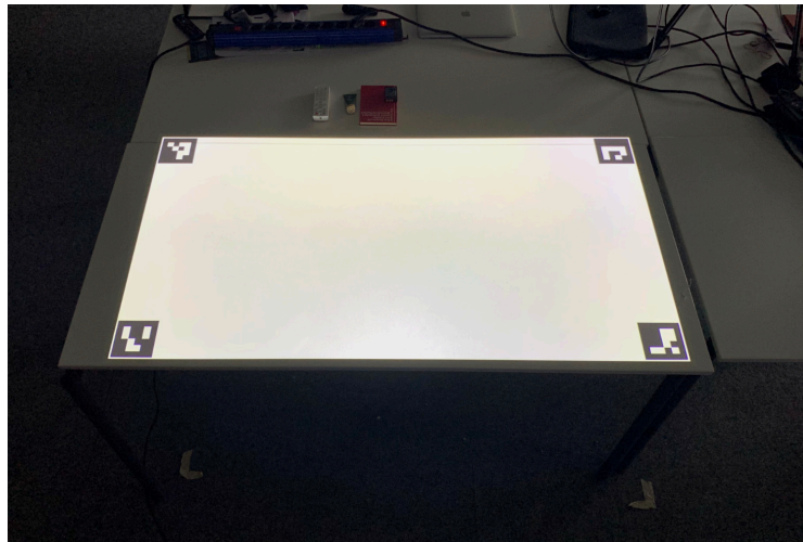
Abbildung 4: Projektion von Aruco Markern zur Kalibrierung zwischen Kamera und Projektor
